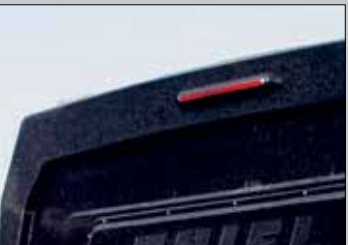
Bremsleuchte zusätzlich oberhalb Heckklappe
