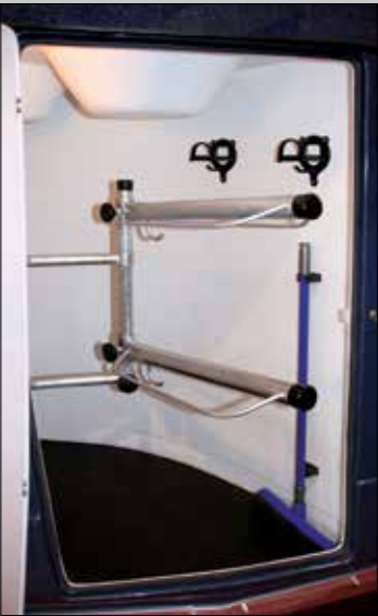
Sattelhalter schwenkbar und höhenverstellbar
