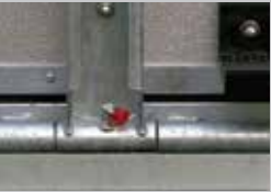
Vier stabile Heckklappenscharniere mit Schmiernippel
