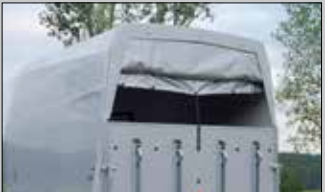
Stufenlos verstellbare Rollplane/ wahlweise Polyklappe
