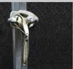
Heckklappenverschluss mit Sicherheitsfeder, 180° drehbar
