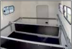
Teleskoptrennwand in der Länge verstellbar, Pferde fahren in der für sie günstigen Position: Rückwärts
