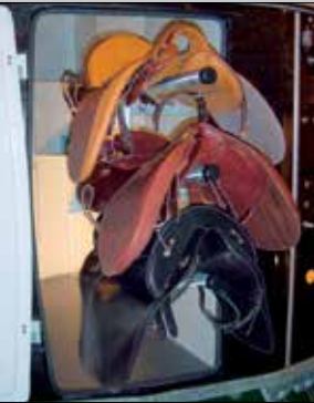
Schwenkbarer Sattelhalter auch für Westernsattel
