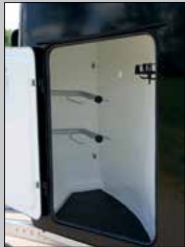
Sattelkammer ohne integrierte Futtertröge. Sattelhalter mit breiter Auflage, Trensenhalter und Zwangsentlüftung, abschließbar
