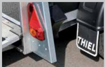
Große Sicherheitsbeleuchtung in geschlossener Seitenstrebe integriert
