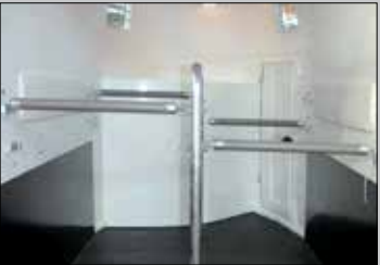
Brust- und Absperrstange höhenverstellbar
