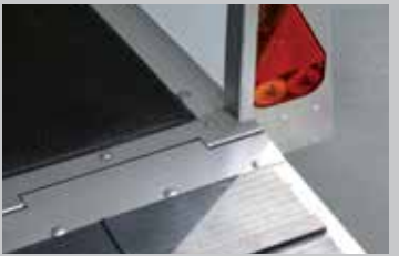
Geschlossenes Klappenscharnier aus EDELSTAHL
