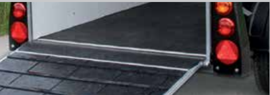
Schmutzschleuse am Übergang Boden/ Heckklappe
