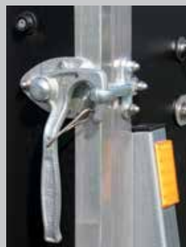
Heckklappenverschluß mit Sicherungsfeder um 180° drehbar
